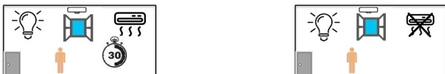
**Tiempo de detección de puerta / ventana:** Es el tiempo que debe estar la puerta abierta antes de que el ahorrador apague el aire acondicionado. Si la puerta/ventana se cierra durante ese tiempo el aire seguirá encendido. Si después de este tiempo (aire apagado) se cierra la puerta el ahorrador volverá a encender el aire acondicionado. Este tiempo está fijado en 30s.
